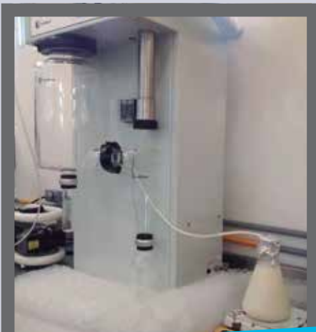
Proceso de secado por aspersión que ofrece un producto en polvo que pierde sólo el 10 por ciento de su calidad nutrimental
