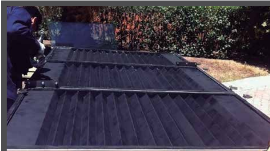
Colector solar plano para el proceso de secado de productos alimenticios
